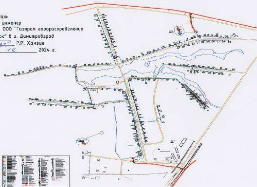
Схема газоснабжения с. Степная Васильевка
